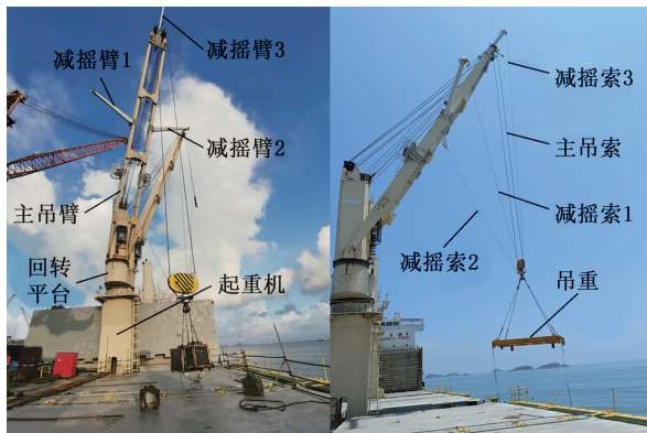
图 5 45 吨船用起重机在船上的工程应用
