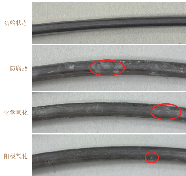
图 5 不同技术处理的 1050 铝导线经中性盐雾试验 120 h 后的外观
