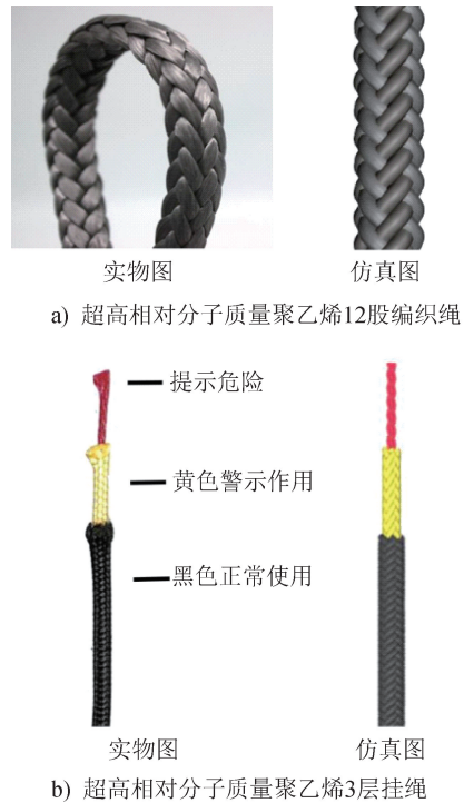
图 13 编织绳仿真效果图 Fig. 13 Simulation effect of braided ropes
