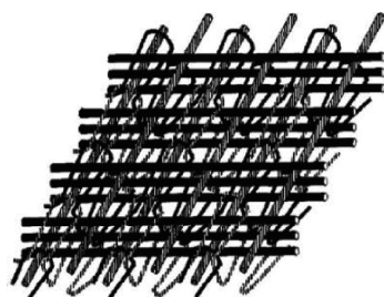
图 1 MBWK 织物结构示意图 [11] Fig. 1 Structure diagram of MBWK fabric [11]
