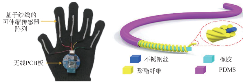
a) YSSA及其在手套上的组装（贴装式集成）
