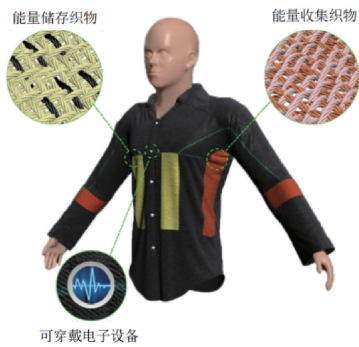
b) 由传输线集成可储存、收集能量的织物
