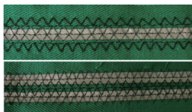
a) 缝制的信号传输线实例
