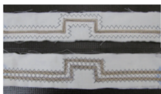
a) 利用缝合技术制作的非直线型导电路径的纺织信号传输线
