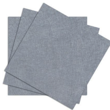
图 3 金属纤维烧结毡 Fig. 3 Sintered felt of metal fiber
