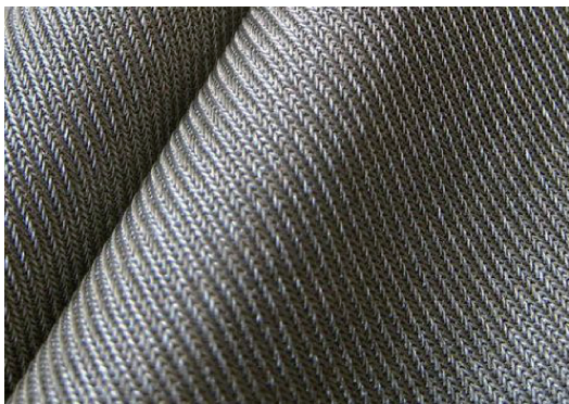
图 2 金属纤维针织物 Fig. 2 Knitted fabric of metal fiber
