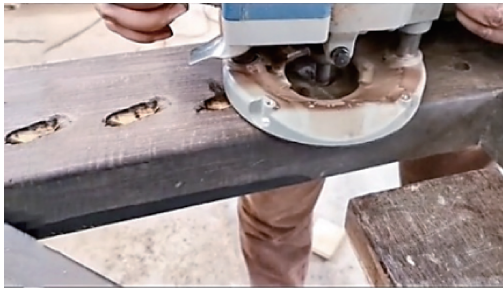
图 16 棕绷架反面孔间的开槽
