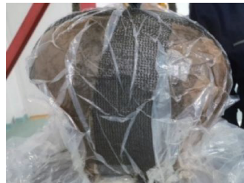
黑色部位—导流网;黄褐色部位—隔离膜。 图 10 利用负压吸附技术获取纤维集束分布 Fig. 10 Obtaining fiber bundles distribution via negative pressure adsorption technology
