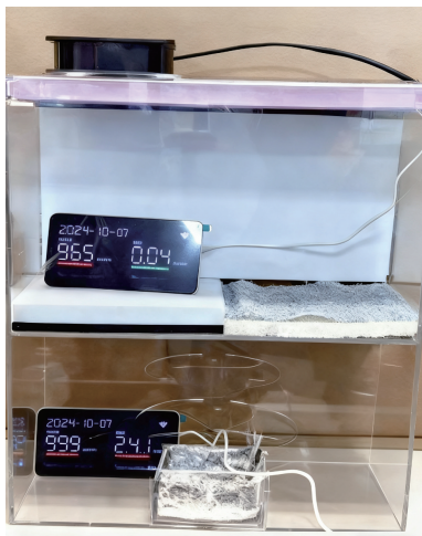
图2 双舱式动态甲醛测试系统
