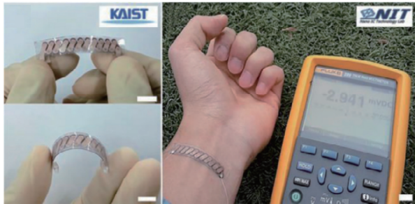
图2 人体体温发电装置 Fig. 2 Body temperature generating device
