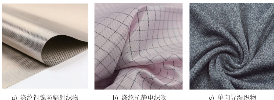
图 1 试验用织物材料照片 Fig. 1 Photos of test fabrics
