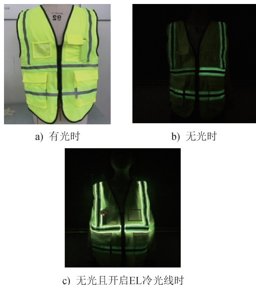
图 2 第二代高可视警示服的发光效果 Fig. 2 Luminous effect of the second generation high visual warning clothing
