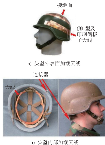
图2 典型头盔天线的加载方式 Fig. 2 Loading modes of typical helmet antennas
