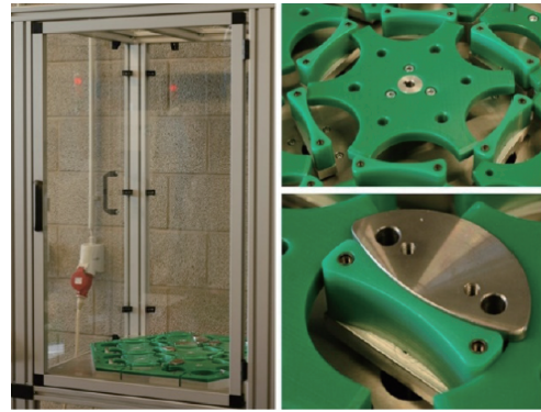
图 9 第二代六角形角轮设计 Fig. 9 Design of the second generation hexagonal corner wheel
