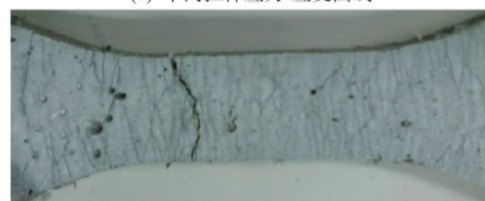
(b) 单向拉伸试件裂缝分布
