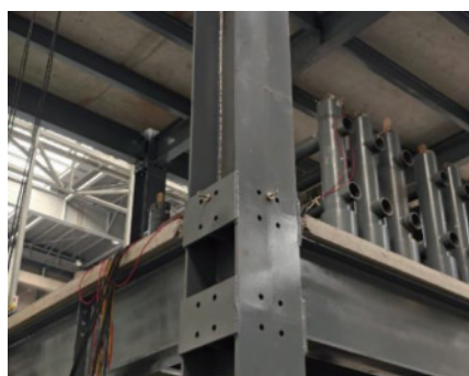
图12 楼面位移计现场布置图
