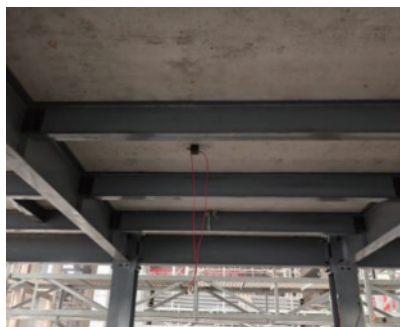
图11 楼面加速度计现场布置图
