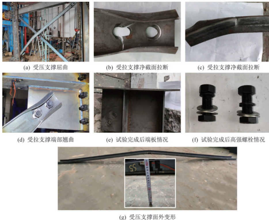
图6 有支撑框架试验现象
