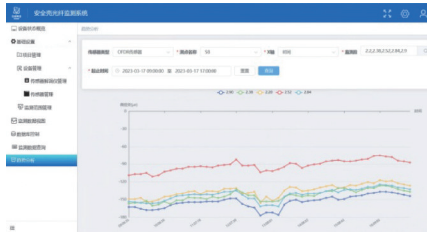
图16 安全壳监测系统趋势分析界面
