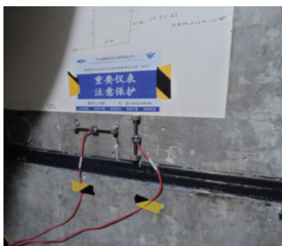
图29 分布式光纤与振弦传感器布设位置
