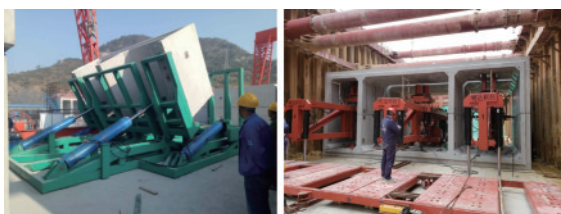
图24 新型预制构件翻转、吊装设备
