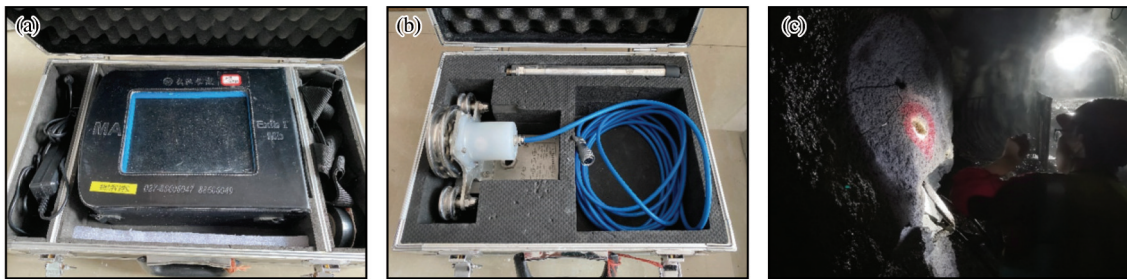
图9 钻孔窥视设备及试验过程
