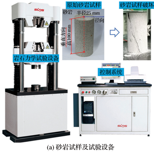
图1 岩石力学试验设备与损伤砂岩波速下降特征
