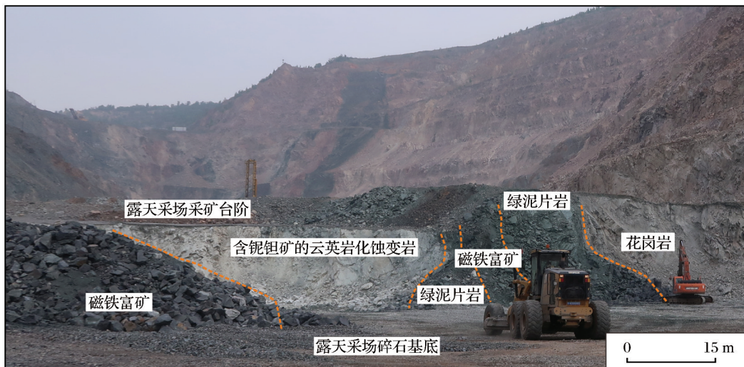
图2 齐大山铁矿伴生铌钽矿体示意图
