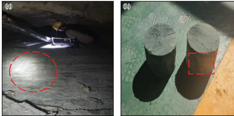
图 15 井下充填料浆凝固情况及井下岩心样品
