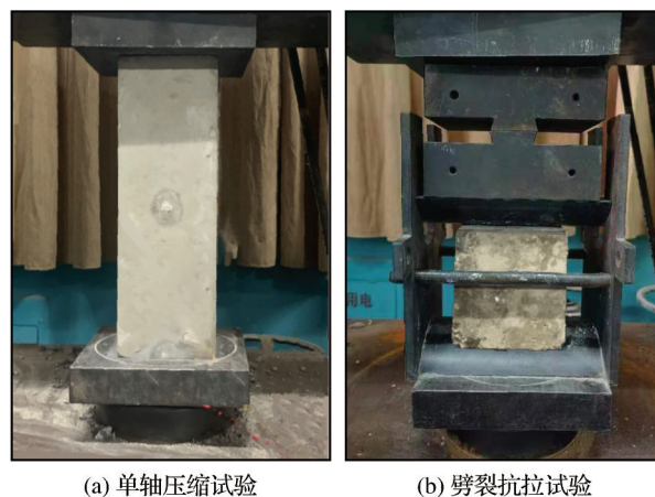
图 8 混凝土力学性能试验
