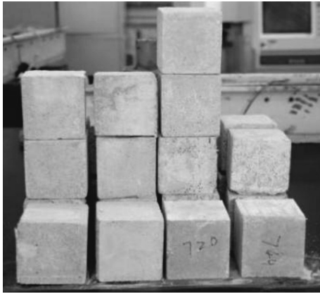
图 1 制备完成的纤维泡沫混凝土试件
