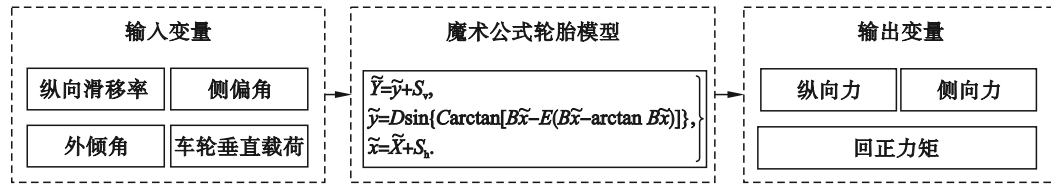
图2 魔术公式轮胎模型的输入和输出变量
