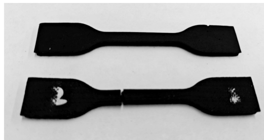
图1 哑铃试件拉伸前后对比
