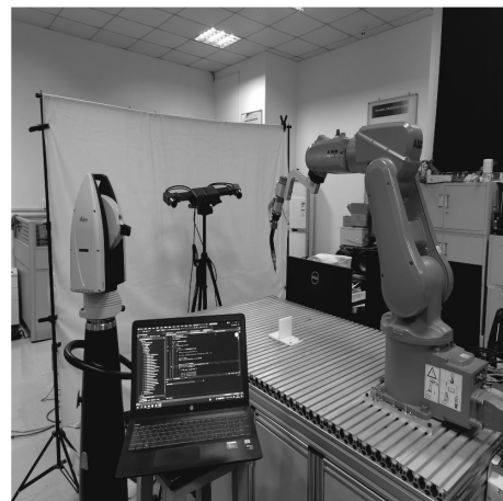
图9 角接焊缝提取实验平台
