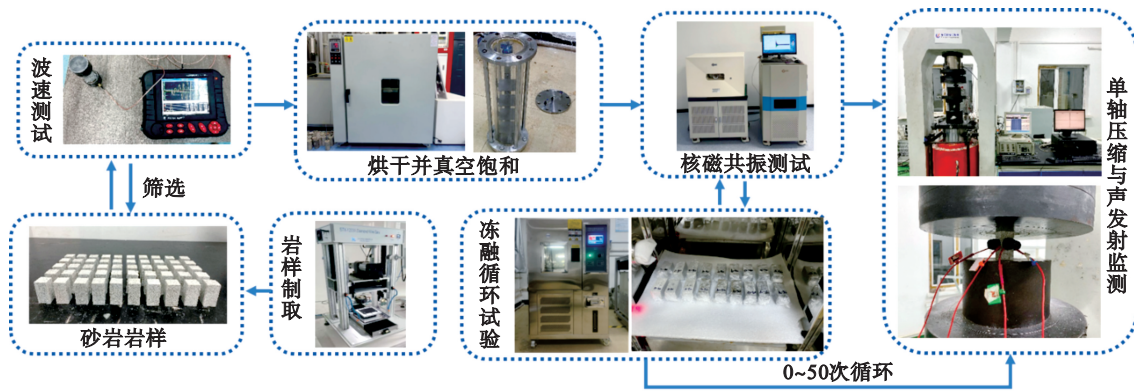
图 1 冻融试验设备及流程
