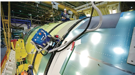
图4 爬行机器人在飞机机身上钻孔加工
