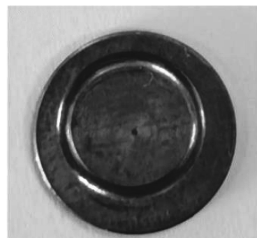
图3 通过激光打孔制作的小孔
