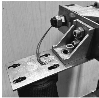
图 15 冲击起子的固定结构
