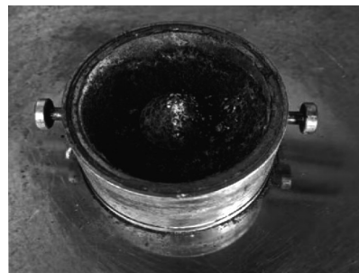
图7 Al/Fe 2 O 3 粉尘层着火后产物照片
