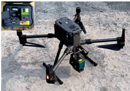
图 2 大疆 M300 无人机及禅思 L1 三维激光扫描仪 Fig. 2 DJI M300 drone and Zenith L1 three-dimensional laser scanner
