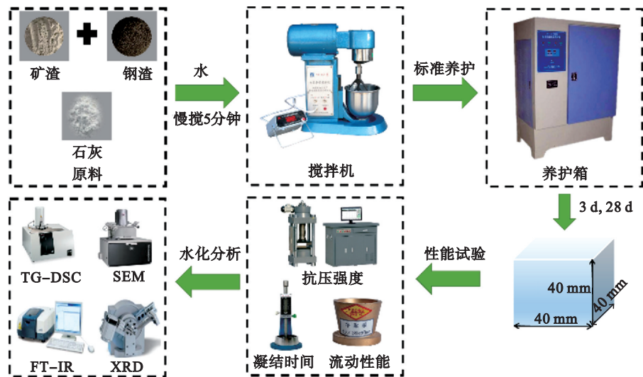
图 3 石灰基矿渣-钢渣复合胶凝材料实验流程
