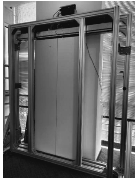
图 7 电梯门机试验台
