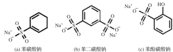
图1 掺杂剂的化学结构
