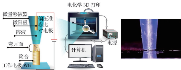
图2 弯月面诱导电化学增材制造流程
