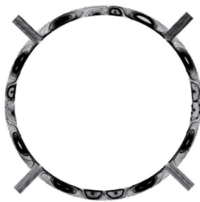
图6 夹套横截面流线图
