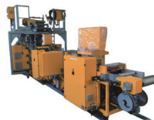
图 2 热塑性预浸料熔融浸渍装置
