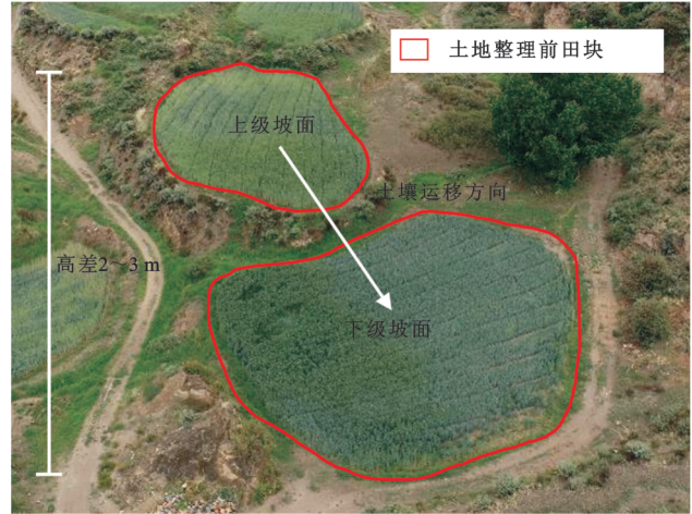
图 2 坡耕地整理工程土地平整示意图 Fig. 2 Schematic diagram of land leveling in sloping farmland consolidation
