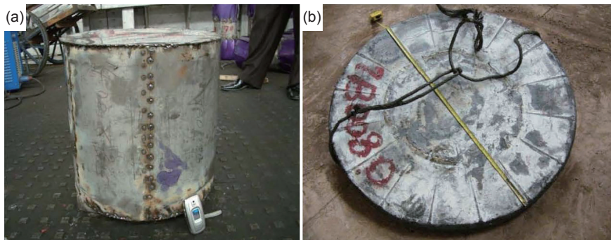
图3 粉末冶金 TiAl 合金锻件 (a)包套;(b)锻坯
