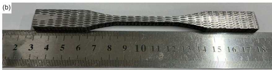
图 3 高温拉伸试样 (a)试样尺寸; (b)试样外观
