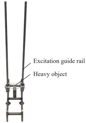
图 3 快开导轨 Fig. 3 Quick-opening guide rail
