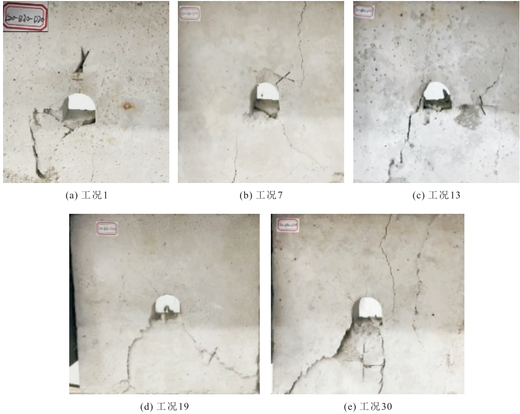
图 3 室内试验得到的模型的破坏模式
