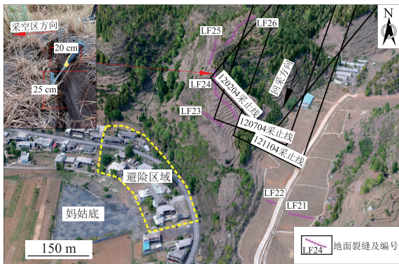
图 4 裂缝分布及变形示意图
