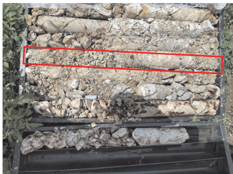
图1 钻孔中砾类土
