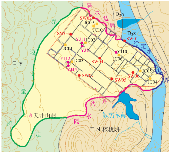
图2 厂区松散层概念模型边界图
