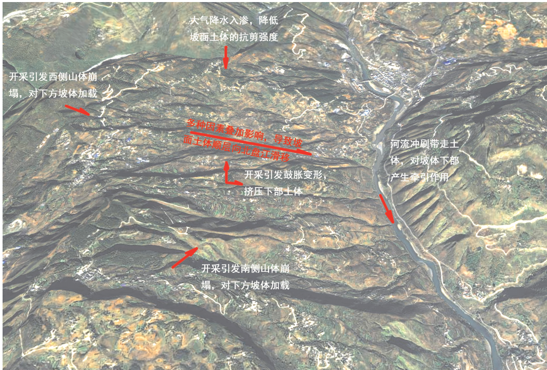
图 7 采动坡体变形模式示意图
