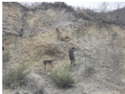
图2 滑坡后缘台坎
